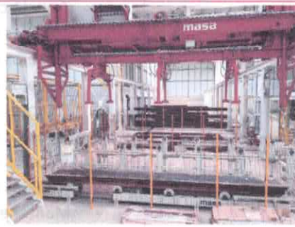
Zona de desmoldeado
